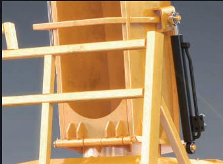
Heittotorvi käännetään kuljetusasentoon 2 sylinterillä
