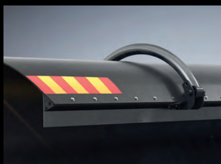
Крыло отвала адаптируется к типу и количеству снега изменяя форму
