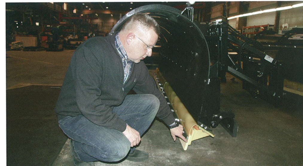
Myyntipäällikkö Jouni Koskela esittelee polyuretaanista valmistettua terän ja aurasiiven välikappaletta, jonka avulla aurasmelua voidaan oleellisesti vähentää.
